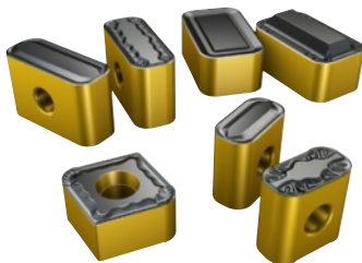
Размер 19, 30 и 32 мм Сплавы GC4325 и GC4215 - Геометрии для черновой, получистовой и чистовой обработки (-PR, -PM, -PF)
